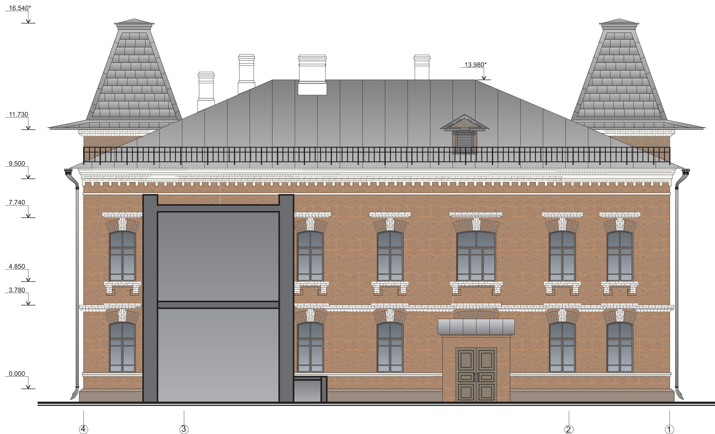
Фасад по оси 4-1. М 1:100
